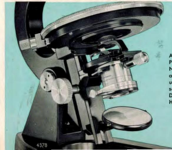
Auswechselbarer, dreilinsiger Polarisationskondensator bs Nr. 56 f mit Aperturblende, ausklappbarem Kondensorteil und ein- und ausschaltbarem, sowie drehbarem Polarisator. Der Kondensator ist in der Höhe verstellbar.
